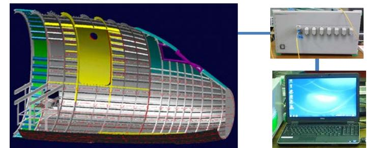
光ファイバセンサを組み込んだ複合材構造
